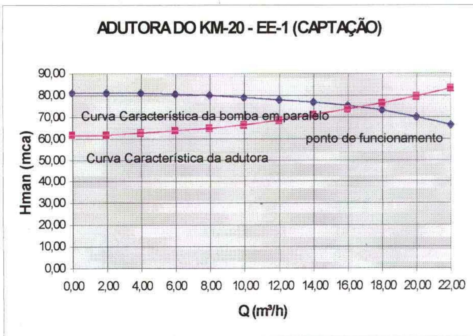
Como pode ser visto na Figura 3.3, no ponto de funcionamento do sistema ter-se-á:
