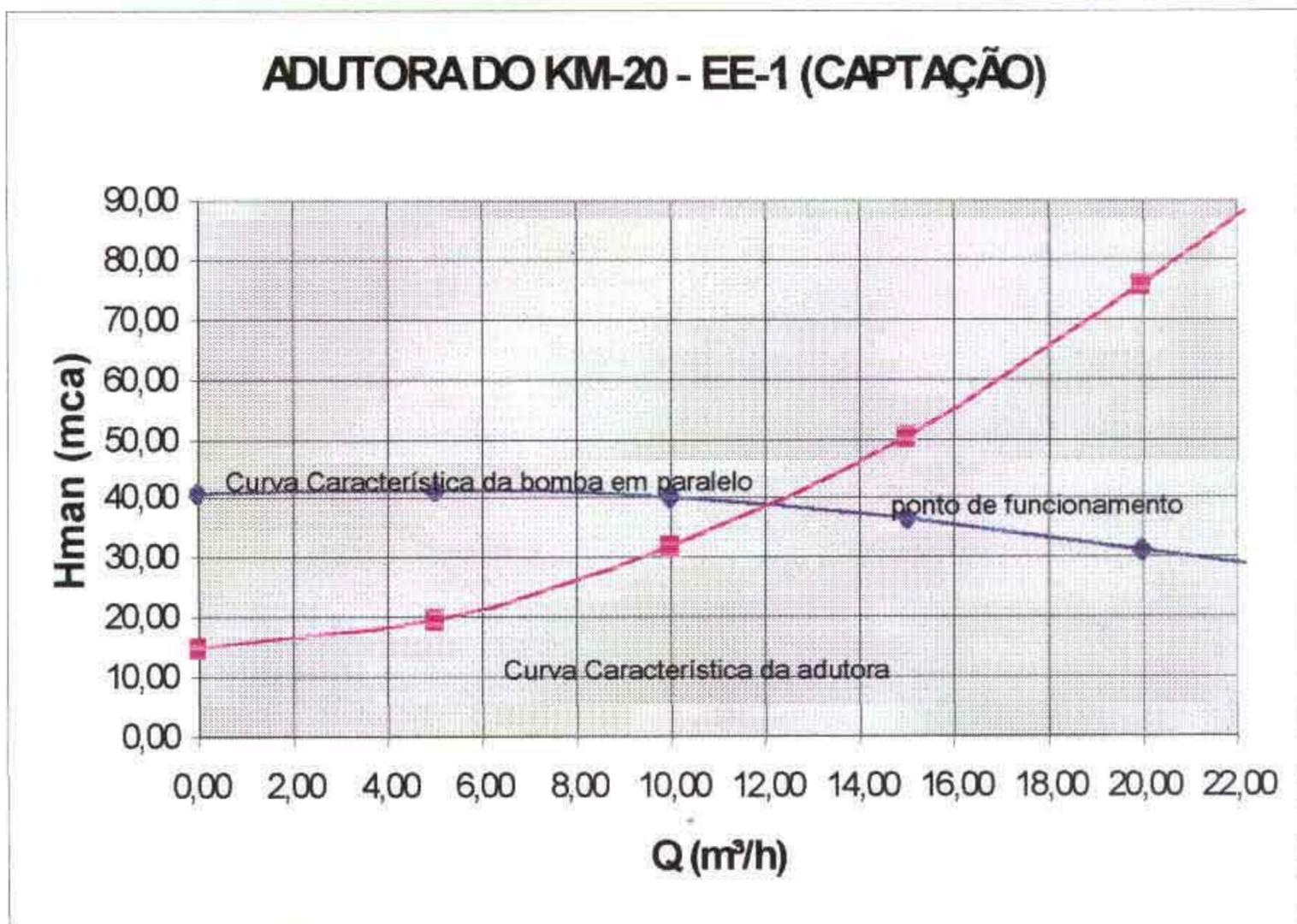
Na Figura 3.6 pode-se ver as curvas características da adutora, da bomba e o ponto de funcionamento do sistema onde ter-se-á:
